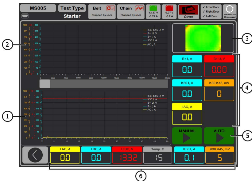
Rysunek 29. Menu trybu badania rozrusznika
