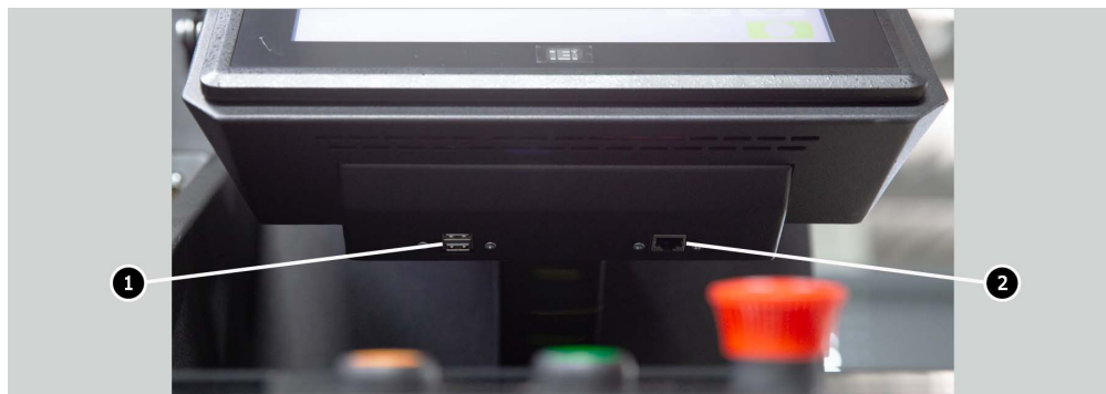
Rysunek 4. Lokalizacja złączy USB i LAN
